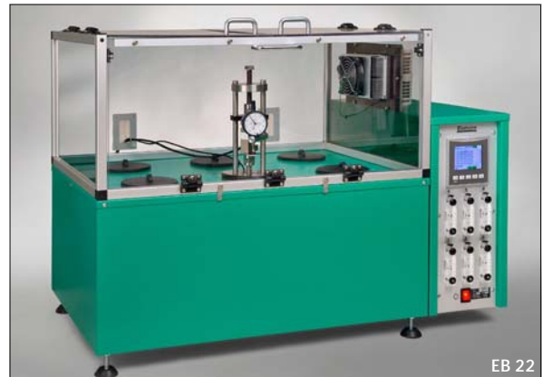
Bild rechts: Behälter für Spannungs- relaxationstests in Flüssigkeiten.
